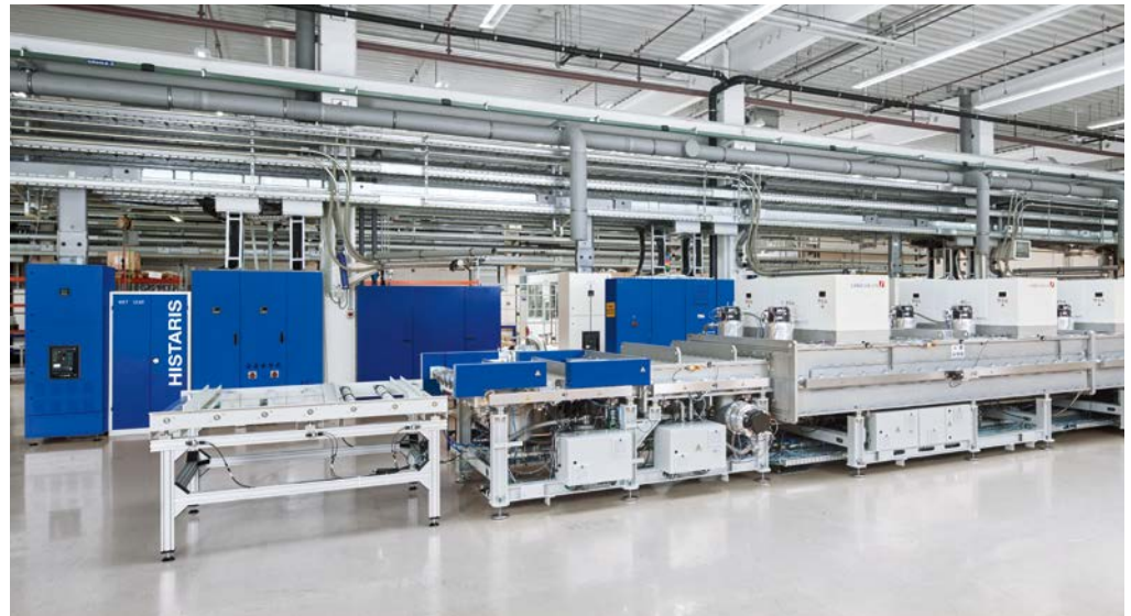
HISTARIS – Inline Kathodenzerstäubungsanlage (Sputtering) mit horizontalem Substrattransport
