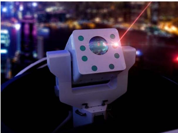
Bodenstationen für Luft-zu-Boden-Verbindungen ermöglichen Laserkommunikation mit Übertragungsraten von bis zu 10 Gbps zwischen Luftfahrzeugen und dem Boden über Entfernungen von bis zu 50 km.
